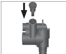
► Setzen Sie den Luftansaugstutzen ein.
