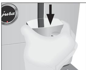
► Setzen Sie die Abdeckung des Kombiauslaufs auf. Sie rastet hörbar ein.
