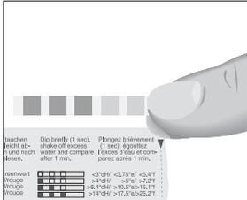
Mit dem im Lieferumfang enthaltenen Aquadur®-Teststäbchen können Sie die Wasserhärte ermitteln.
