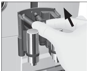
► Setzen Sie die zusammengesteckten Einzelteile wieder in den Kombiauslauf ein und drücken Sie sie fest.
