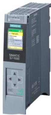
\*\*\* Ersatzteil \*\*\* SIMATIC S7-1500F, CPU 1511F-1 PN, Zentralbaugruppe mit Arbeitsspeicher 225 KB für Programm und 1MByte für Daten, 1. Schnittstelle: PROFINET IRT mit 2 Port Switch, 60 NS Bit-Performance, SIMATIC Memory Card notwendig
