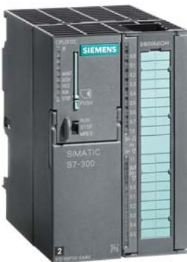
\*\*\*Ersatzteil\*\*\* SIMATIC S7-300, CPU 312C Kompakt-CPU mit MPI, 10 DE/6 DA, 2 schnelle Zähler (10 kHz) integr. Stromversorgung DC 24V, Arbeitsspeicher 64 KByte, Frontstecker (1x 40-polig) und Micro Memory Card erforderlich
