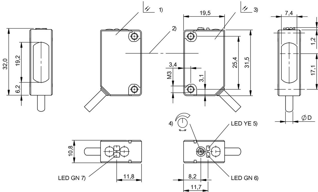
1) Sender, 2) Optische Achse, 3) Empfänger, 4) Empfindlichkeit, 5) Ausgangsfunktion, 6) Stabilität, 7) Betriebsspannung
