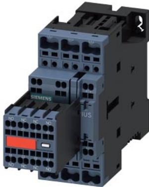
Leistungsschütz, AC-3e/AC-3, 12 A, 5,5 kW / 400 V, 3-polig, DC 24 V, mit eingestecktem Varistor, Hilfskontakte: 2 S + 2 Ö, Federzuganschluss, Baugröße: S0, Hilfsschalter unlösbar
