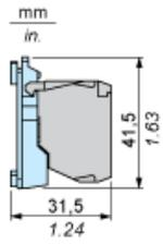
mit ZB4BZ009 Befestigungsflansch
