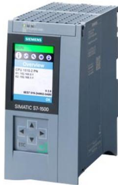
\*\*\* Ersatzteil \*\*\* SIMATIC S7-1500, CPU 1515-2 PN, Zentralbaugruppe mit Arbeitsspeicher 500 KB für Programm und 3MByte für Daten, 1. Schnittstelle: PROFINET IRT mit 2 Port Switch, 2. Schnittstelle: PROFINET RT, 30 ns Bit-Performance, SIMATIC Memory Card notwendig
