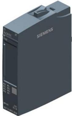
SIMATIC ET 200SP, Digitales Eingangsmodul, DI 8x 24VDC Standard, Eingangstyp 3 (IEC 61131), Sink Input, (PNP, P-lesend), Verpackungseinheit: 1 Stück, passend für BU-Typ A0, Farocode CC01, Eingangsverzögerung 0,05..20ms; Modul-Diagnose für: Kurzschluss Geberversorgung, Drahtbruch, Versorgungsspannung
