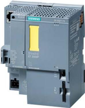
\*\*\* Ersatzteil \*\*\* SIMATIC DP, CPU 1510SP F-1 PN für ET 200SP, Zentralbaugruppe mit Arbeitsspeicher 150 KB für Programm und 750 KB für Daten, 1. Schnittstelle: PROFINET IRT mit 3 Port Switch, 72 NS Bit-Performance, SIMATIC Memory Card notwendig, Busadapter notwendig für Port 1 und 2
