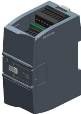
SIMATIC S7-1200, analoge E/A SM 1234, 4 AI/2 AO, +/-10V, 14 Bit Auflösung oder 0 (4)-20mA, 13 Bit Auflösung
