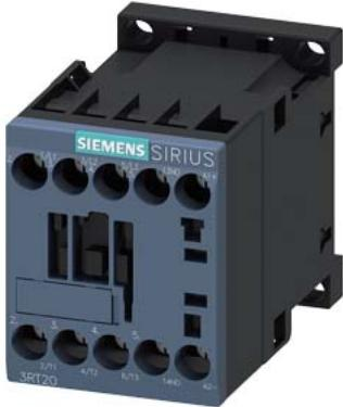
Leistungsschütz, AC-3e/AC-3, 7 A, 3 kW / 400 V, 3-polig, DC 24 V, Hilfskontakte: 1 S, Schraubanschluss, Baugröße: S00
