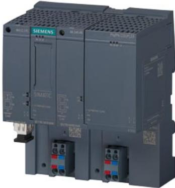
SIMATIC PN/PN Coupler zum deterministischen Datenaustausch zwischen max. 4 PN-Controllern je Seite, auch über Netzgrenzen, Übertragung von PROFI-safe, I/O-, MSI-, MSO- und Datensatz- kommunikation, redundante Stromspeisung PN-Anschluss über SIMATIC BusAdapter (BA), Lieferung ohne BusAdapter
