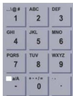
Die folgende Abbildung zeigt die alphanumerischen Eingabetasten des KP300 Basic mono PN, welche in die Funktionstasten integriert sind.
