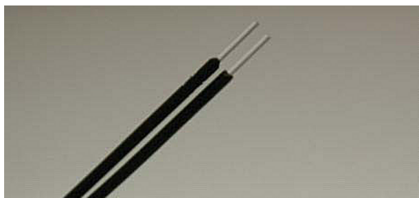
Abb. 34: POF-Kabel auf gleiche Länge abisoliert
