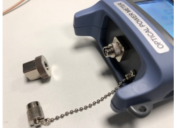
OPM mit aufgeschraubtem FC Adapter
