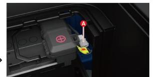
3. Markiertes Kabel am Sicherungskasten durchschneiden.
