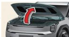
2. Motorhaube öffnen & Batterieabdeckung öffnen
