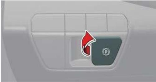
1. Räder verkeilen und Taste betätigen, um die Feststellbremse einzulegen.
