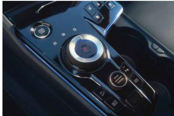
**Gangwahl-Drehschalter\*.** Der Gangwahl-Drehschalter liegt zentral und ist gut erreichbar. Er basiert auf der Shift-by-Wire-Technologie und erlaubt geschmeidige Schaltvorgänge. Sicher ist sicher: Der Gangwahl-Drehschalter schaltet automatisch auf «P», wenn der Fahrer dies vergisst.
