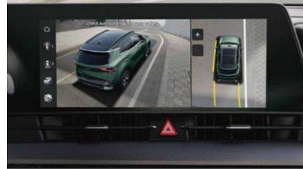
**360° Monitor Rundumsichtkamera mit 3D Darstellung (SVM).** Beim Manövrieren auf engem Raum werden Sie von mehreren Kameras unterstützt, die Ihnen eine 360° Rundumsicht mit Zoomfunktion über die direkte Umgebung des Fahrzeugs geben. So manövrieren Sie Ihr Fahrzeug sicher, ohne aussteigen oder andere um Hilfe bitten zu müssen.
