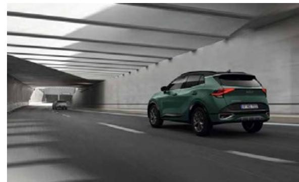
**Autobahnassistent (HDA).** Der Autobahnassistent ermöglicht entspanntes Fahren auf der Autobahn, denn er hält den Sportage selbstständig mittig in der Fahrspur und gewährleistet einen Sicherheitsabstand zum vorausfahrenden Fahrzeug. Dabei steuert er die Geschwindigkeit, beschleunigt und bremst nach Bedarf ab. Unter bestimmten Bedingungen passt das System die Geschwindigkeit des Sportage sogar an die Geschwindigkeitsbegrenzungen an, die ihm vom Navigationssystem gemeldet werden.
