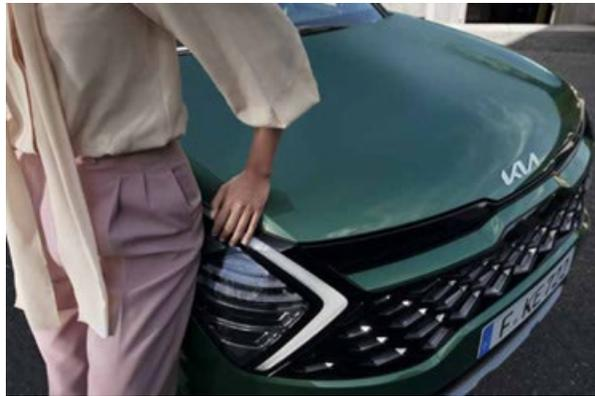
**Intelligentes Scheinwerfersystem (IFS)\*.** Eine Scheinwerfer-technologie, die eindeutig neue Maßstäbe setzt. Wenn Sie die Matrix-LED-Scheinwerfer auf Fernlicht geschaltet haben und das intelligente Scheinwerfersystem ein vorausfahrendes oder entgegenkommendes Fahrzeug entdeckt, schaltet es automatisch auf Abblendlicht um, damit der andere Fahrer nicht geblendet wird. Ist die Strasse frei, schaltet sich das Fernlicht automatisch wieder ein.
