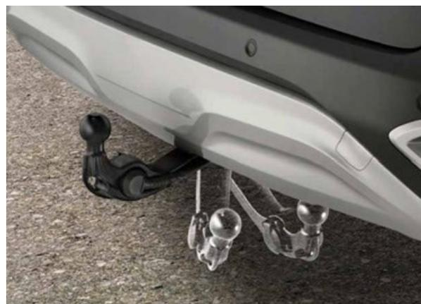
**Anhängerkupplung, versenkbar.** Noch mehr Komfort und eine effiziente Transportlösung gewünscht? Die hochwertige, voll-elektrische Anhängerkupplung lässt sich über einen Schalter im Kofferraum versenken und ausfahren. Wird sie nicht gebraucht, sitzt sie zusammengeklappt und unsichtbar hinter dem unteren Stossfänger.
