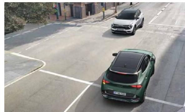
**Autonomer Notbremsassistent (FCA).** Das FCA-System wertet die Kamera- und Radardaten Ihres Fahrzeugs aus und analysiert die Informationen zu anderen Fahrzeugen, Fussgängern oder Velofahrern, die ihre Spur kreuzen, um eine mögliche Kollision zu verhindern. FCA dient auch dazu, Kollisionen beim Linksabbiegen an Kreuzungen zu vermeiden. Wird eine mögliche Kollision erkannt, erscheint ein Warnsignal auf Ihrer Instrumenteneinheit und das Fahrzeug bremst maximal ab.
