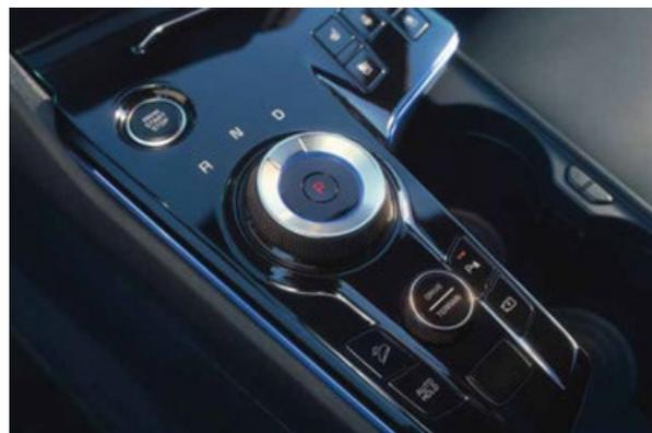
**Cadran rotatif de changement de vitesse\*.** Le cadran rotatif, judicieusement positionné au centre, fonctionne selon la technologie «shift-by-wire», pour des changements de vitesse sans effort. Autre point fort en termes de sécurité: le cadran bascule automatiquement sur le rapport de stationnement «P» en cas d'oubli du conducteur.
