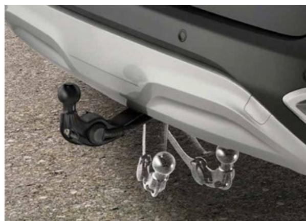
**Barre de remorquage rétractable.** Vous souhaitez un mode de transport efficace avec encore plus de confort? Cette barre de qualité supérieure entièrement électrique se déploie et se rétracte à l'aide d'un interrupteur logé dans le coffre; après utilisation, elle se redresse et s'escamote derrière le pare-chocs inférieur.
