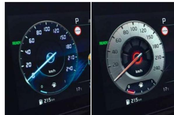
**Combiné d'instruments Supervision 12.3" digital\*.** Le combiné est équipé d'un écran à cristaux liquides à transistors à couches minces (TFT-LCD), pour des graphiques au rendu incroyablement précis et clair. En fonction du groupe motopropulseur utilisé, le tout nouveau Sportage offre une gamme de modes de conduite allant du mode Eco au mode Sport.
