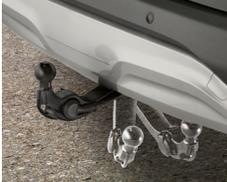
Elektrisch ausfahrbare Anhängerkupplung inkl. Elektro Satz 13 polig
