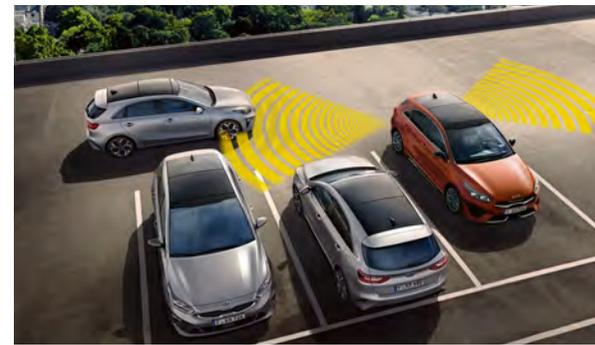
**Rückfahr-Querverkehrwarner (RCCA).** Beim seitlichen Einparken oder beim Rückwärtsfahren aus einer Parklücke oder Einfahrt warnt Sie das radargestützte Querverkehr-Erkennungssystem vor möglichem Querverkehr und bremst das Fahrzeug ab, um eine Kollision zu vermeiden.
