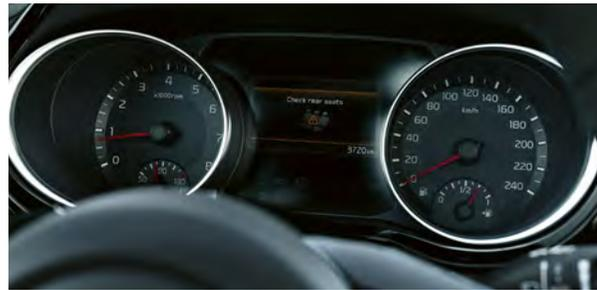
**4,2" Supervision-Cluster.** Das intelligent konzipierte Supervision-Cluster mit 4,2" LCD-Display zeigt die Aussentemperatur sowie Fahrzeug- und Reisedaten an. Seine Einstellungen lassen sich anpassen.
