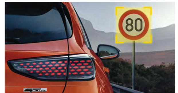
**Anzeige Tempolimit (ISLW).** Die intelligente Höchstgeschwindigkeitswarnung liefert alle nötigen Daten, die Ihnen das Einhalten der Geschwindigkeitsbegrenzungen erleichtern. Über die Kamera an der Frontscheibe erfasst er Geschwindigkeitsbeschränkungen und Überholverbote und zeigt diese Informationen auf dem Display der Navigations- und Instrumenteneinheit an.
