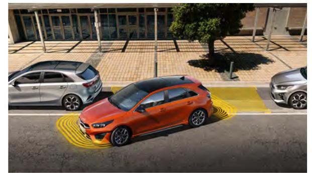
**Automatische Parkhilfe (SPA).** Mit der automatischen Parkhilfe wird Parkieren zum Kinderspiel. Das auf Front-, Seiten- und Hecksensoren gestützte System hilft Ihnen beim Einfahren in Längs-, Schräg- und Querlücken. Sie müssen nur noch bremsen, Gas geben und schalten. Das Lenken übernimmt der Assistent. Er hilft Ihnen sogar beim Ausfahren aus Längsparklücken.
