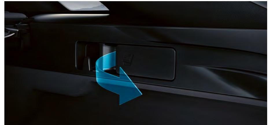
**Umklappen auf Knopfdruck.** So wird das Einladen zur schnellen und mühelosen Routine: Sie betätigen einfach den Hebel im Gepäckraum und die Sitzlehnen klappen von selbst um.
