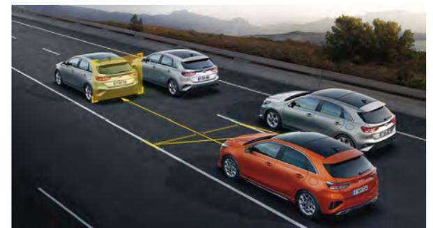
**Autobahnassistent (HDA).** Der Autobahnassistent ermöglicht entspanntes Fahren auf der Autobahn, denn er hält den Ceed automatisch mittig in der Fahrspur und gewährleistet einen Sicherheitsabstand zum vorausfahrenden Fahrzeug. Dabei steuert er die Geschwindigkeit, beschleunigt und bremst nach Bedarf ab. Unter bestimmten Bedingungen passt das System die Geschwindigkeit des Ceed automatisch an die Geschwindigkeitsbegrenzungen an, die ihm vom Navigationssystem gemeldet werden.
