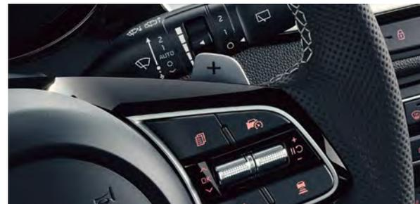
**Schaltwippen am Lenkrad.** Mit den Schaltwippen wechseln Sie problemlos die Gänge, ohne die Hände vom Lenkrad zu nehmen. So fahren Sie nicht nur dynamischer und intuitiver, sondern auch sicherer – mit beiden Händen am Lenkrad.
