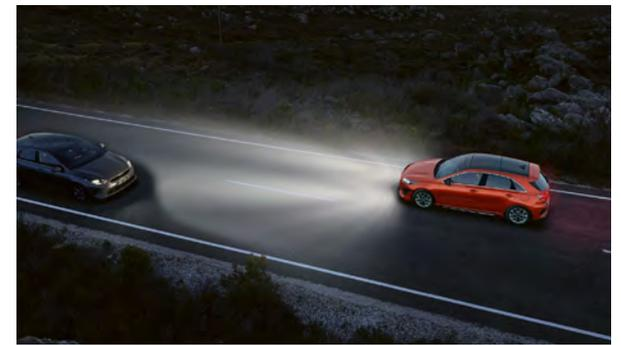
**Fernlichtassistent (HBA).** Erkennt die Kamera in der Windschutzscheibe bei Dunkelheit die Scheinwerfer eines entgegenkommenden Fahrzeugs, schaltet der Fernlichtassistent automatisch auf Abblendlicht um, damit der andere Fahrer nicht geblendet wird. Sobald das entgegenkommende Fahrzeug vorbei gefahren ist, wird das Fernlicht automatisch wieder eingeschaltet.
