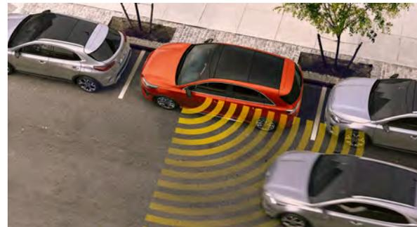
**Assistant de sortie du véhicule (SEW).** Ce système conçu pour vous aider à sortir de votre Ceed détecte les dangers potentiels en approche. Il émet alors une alerte acoustique et visuelle.
