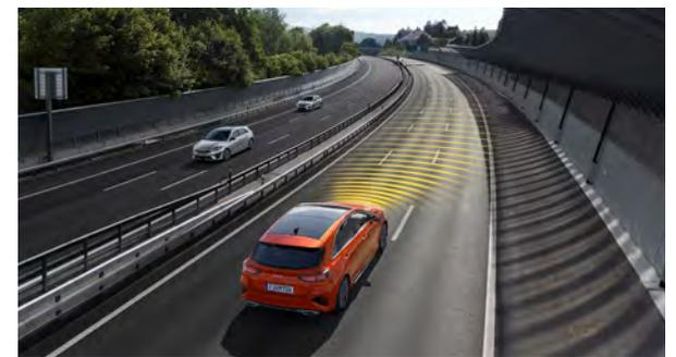
**Tempomat et assistant virage assisté par la navigation (NSCC).** Utilisée en association avec l'assistant à la conduite sur autoroute (HDA), le système NSCC-C exploite les données de navigation pour anticiper les virages et réduire alors la vitesse de croisière puis, en sortie de virage, ramener la vitesse au niveau prédéfini si les conditions le permettent.
