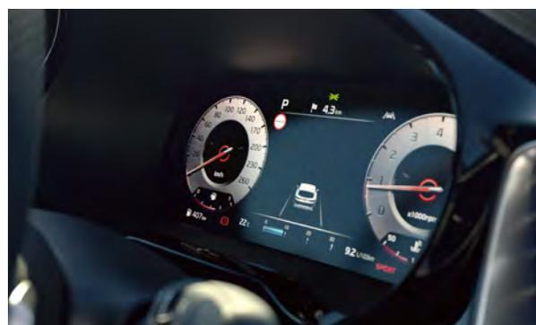
**Affichage des instruments 12,3".** Le tableau de bord entièrement numérique comprend un écran haute définition de 12,3 pouces avec quatre thèmes différents. Vous pouvez ainsi suivre les informations de diagnostic du véhicule et de voyage quasiment en temps réel - par exemple le niveau de carburant et la pression des pneus.
