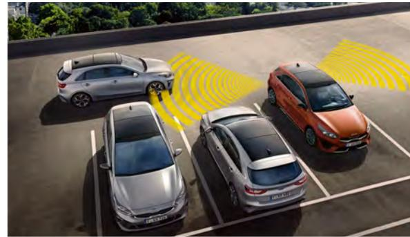
**Avertisseur de trafic transversal en marche arrière (RCCA).** Lorsque vous effectuez un créneau ou que vous quittez une place de stationnement ou une allée en marche arrière, le système anti-collision de détection de trafic arrière exploite les données d'un radar pour vous avertir le cas échéant du croisement imminent de véhicules et actionne les freins pour éviter une collision.
