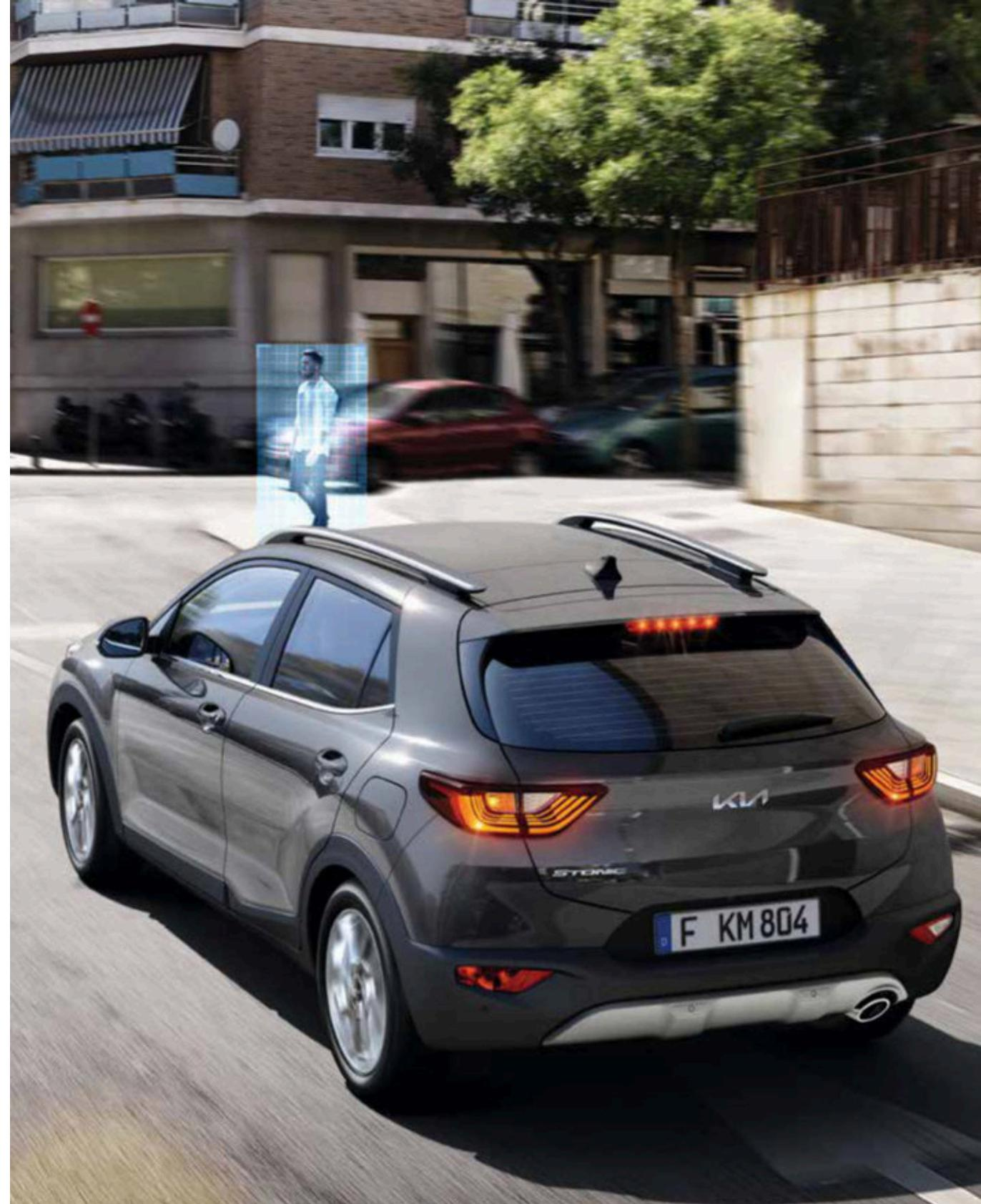
**Autonomer Notbremsassistent (FCA).** Dank einer Kombination von Radar- und Kameradaten aktiviert der Autonome Notbremsassistent die Bremsen, wenn ein vorausfahrendes Auto abrupt bremst, und kann so bei Geschwindigkeiten von bis zu 60 km/h vollständig stoppen. Bei Kollisionsgefahr mit Personen, die zu Fuss oder mit dem Fahrrad unterwegs sind, warnt Sie der Frontkollisionssensoren. Falls Sie nicht reagieren, bremst er für Sie ab, um eine Kollision zu vermeiden oder abzumildern.
