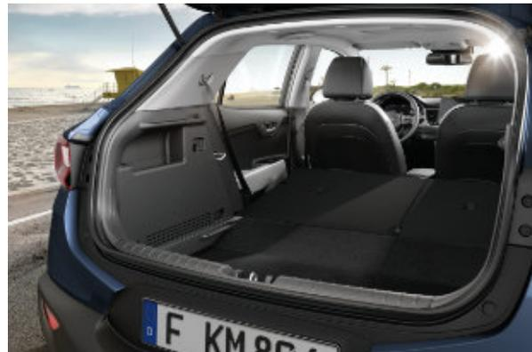
**Verstellbarer Kofferraumboden.** Erhöhen Sie den Kofferraumboden, damit er bündig mit den umgeklappten Sitzlehnen ist (links) oder senken Sie ihn, um hohe Gegenstände zu verstauen (rechts). (Bei Mild-Hybrid-Modellen befindet sich die Ladefläche immer in der tieferen Position).
