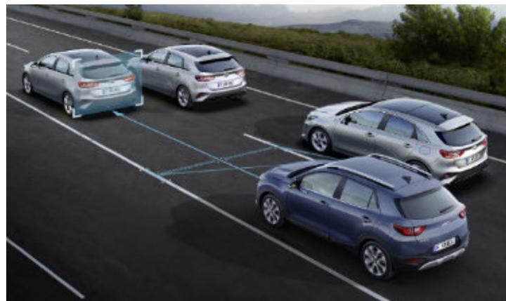
**Spurfolgeassistent (LFA).** Das System nutzt Kamera- und Radarsensoren, um den Sicherheitsabstand zum Fahrzeug vor Ihnen einzuhalten, und überwacht die Fahrbahnmarkierungen, um Ihr Fahrzeug in der Mitte der Fahrbahn zu halten.
