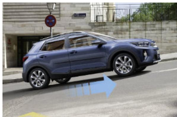
**Berganfahrassistent (HAC).** An einer steilen Stelle kann das Anfahren zum Problem werden. Aber keine Sorge - der Berganfahrassistent (Hill-start Assist Control, HAC) verhindert das Zurückrollen des Fahrzeugs.
