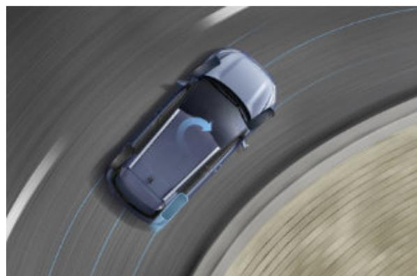
**Kurvenbremskontrolle (CBC).** Die Kurvenbremskontrolle (Cornering Brake Control, CBC) wurde entwickelt, damit Sie beim Abbiegen in der Spur bleiben. Sie wendet beim Bremsen in der Kurve eine asymmetrische Bremskraft auf die einzelnen Räder an, was einem möglichen Traktionsverlust entgegenwirkt und somit die Sicherheit erhöht.
