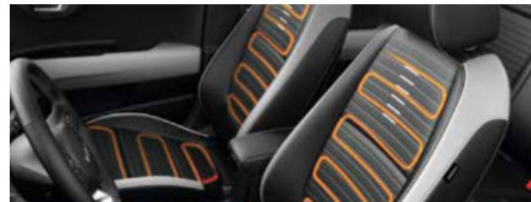
**Sitzheizung vorne.** Mit 3 variablen Wärmestufen lassen sich die beheizten Vordersitze und Rückenlehnen rasch aufheizen. Sobald die gewünschte Temperatur erreicht ist, flacht die Heizkurve ab und sorgt so für optimalen Komfort und Sicherheit.
