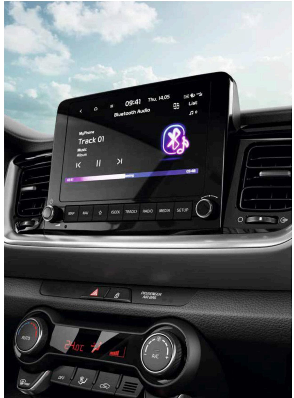
**8" Navigationssystem.** Das mehrsprachige System umfasst einen hochauflösenden 8" TFT-LCD-Bildschirm und eine Rückfahrkamera.
