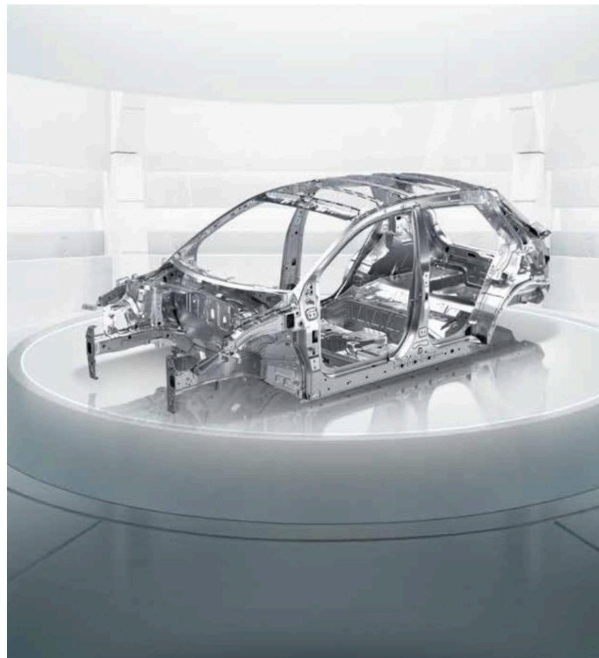
**Ultrahochfester Stahl (AHSS) für grössere Stabilität und zusätzlichen Schutz der Fahrgastzelle.** Der beim Kia Stonic verwendete ultrahochfeste Stahl (Advanced High Strength Steel, AHSS) sorgt durch eine durchschnittlich höhere Zugfestigkeit für eine phänomenale Karosseriesteifigkeit und verbessert so den Schutz der Fahrgastzelle sowie die dynamische Leistung.
