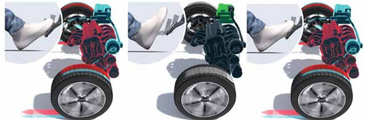
**Segel-Modus.** Wenn der Fahrer den Fuss vom Gaspedal nimmt und das Fahrzeug einfach ausrollen lässt, wird der Motor nahtlos ausgeschaltet, was zu mehr Effizienz führt. Sobald das Gaspedal wieder betätigt wird, übernimmt der Motor sofort. Die Nutzung der Segel-Funktion und die Reichweite bei ausgeschaltetem Motor hängen von den Fahrbedingungen und der Fahrzeuggeschwindigkeit ab.
