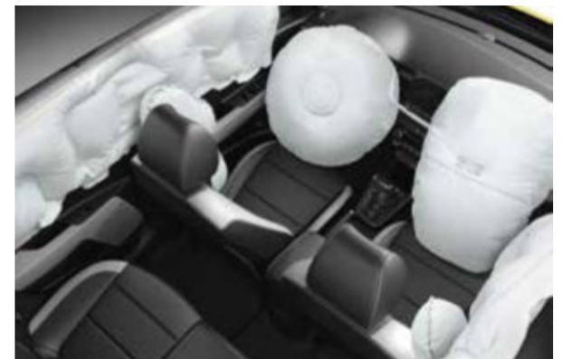
**6 airbags.** Pour mieux protéger les occupants, le véhicule est doté d'airbags frontaux pour le conducteur et le passager avant, de deux airbags latéraux, et de deux airbags rideaux le long de l'habitacle.
