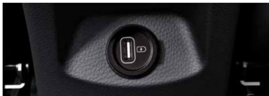
**Chargeur USB arrière.** Un port USB situé à l'arrière de la console centrale permet également aux passagers arrière de recharger eux aussi leurs appareils.
