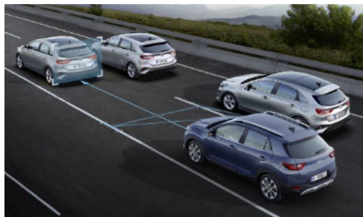
**Assistant de maintien dans la voie (LFA).** Ce système utilise une caméra et des capteurs radar pour maintenir une distance de sécurité avec le véhicule qui précède et surveille les marquages au sol pour maintenir le véhicule au centre de sa voie de circulation.
