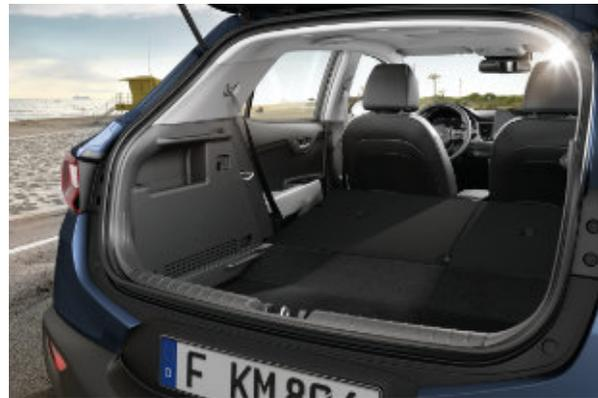
**Plancher de coffre modulable.** Rehaussez le plancher de l'espace de chargement (à gauche) pour l'aligner avec la banquette rabattue ou abaissez-le (à droite) pour ranger des objets encombrants. (Le plancher du coffre des versions hybride rechargeable est toujours en position basse.)
