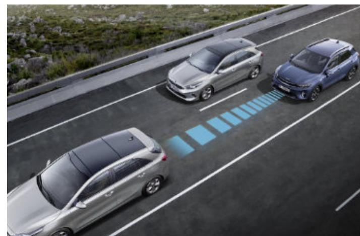
**Tempomat avec assistance de distance (SCC).** Au moyen d'un radar embarqué, le régulateur de vitesse intelligent contrôle la vitesse et la distance par rapport à la voiture qui précède votre Stonic. Le système maintient la distance par rapport au véhicule qui le précède en ajustant automatiquement votre vitesse. S'il ralentit et que la distance de sécurité prédéterminée ne peut être maintenue, le système décélère. S'il accélère, votre Stonic accélère jusqu'à la vitesse définie.
