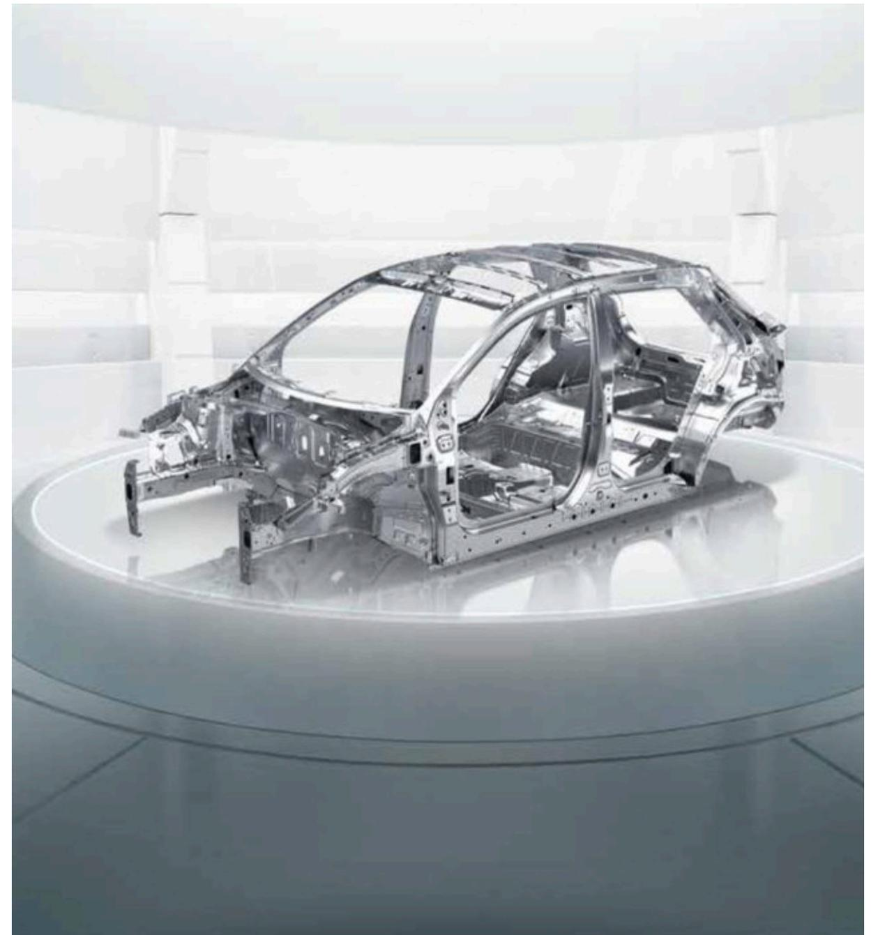
**Acier AHSS pour une plus grande résistance et une protection accrue dans l'habitacle.** La Stonic est composée d'acier avancé à haute résistance (AHSS) qui accroît la résistance moyenne à la traction, ce qui apporte à la carrosserie énormément de rigidité, renforce la protection dans l'habitacle et la performance dynamique.
