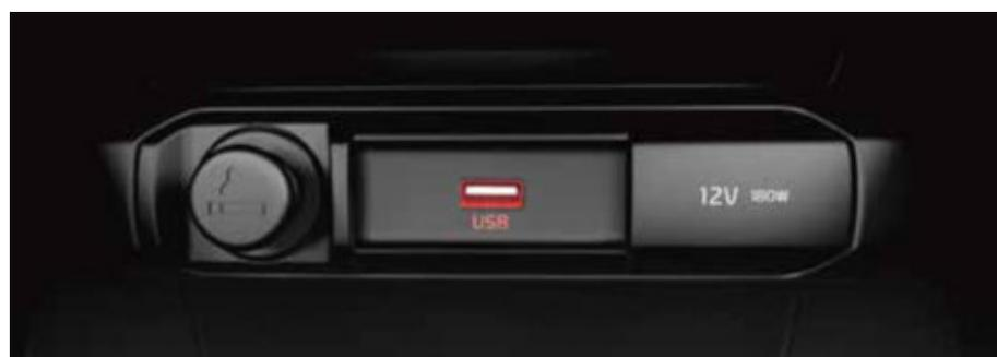
**Chargeur USB avant.** Un port USB permet de recharger les téléphones portables et autres appareils compatibles.
