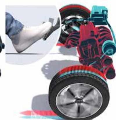
**Mode Voile.** Lorsque le conducteur lève le pied de l'accélérateur et laisse la voiture naviguer sans accélérer ni freiner, selon le niveau de charge de la batterie de 48 volts, le moteur s'éteint en douceur, ce qui permet une conduite plus efficace. Dès que l'on appuie sur l'accélérateur ou les freins, le moteur prend immédiatement le relais. La fonction de navigation et la distance parcourue avec le moteur éteint dépendent des conditions de conduite et de la vitesse du véhicule.
