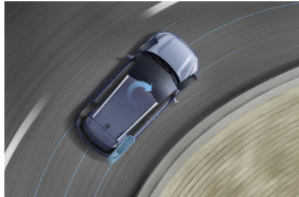
**Contrôle électronique de trajectoire (CBC).** Conçu pour vous aider à rester sur la bonne trajectoire dans les virages, le CBC applique une force de freinage asymétrique à chaque roue au moment de freiner dans un virage, ce qui permet de contrer une perte éventuelle de traction et se traduit par une plus grande sécurité.
