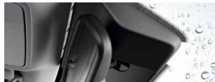
**Capteur de pluie.** Le capteur de pluie active les essuie-glaces lorsqu'il détecte des gouttes de pluie sur le pare-brise.
