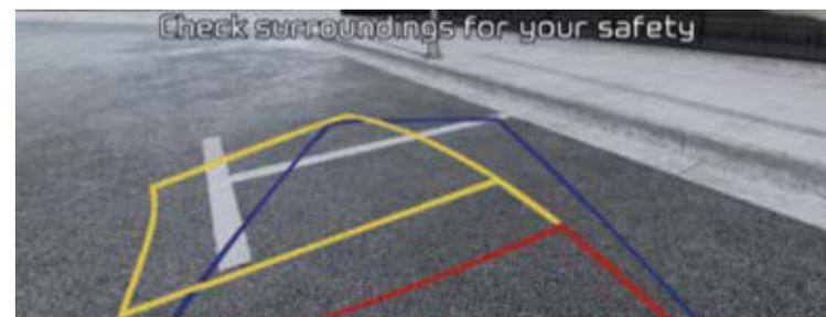
**Écran de surveillance périmétrique.** La caméra de recul projette des lignes de guidage dynamiques sur l'écran de 8" du tableau de bord pour recommander une trajectoire.
