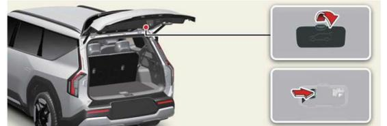
Retirer le cache qui se trouve tout en bas du hayon puis tirer sur le bouton dans le sens de la flèche pour déverrouiller le hayon.
