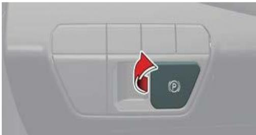
1. Bloquer les roues et tirer sur le bouton pour mettre le frein de stationnement.
