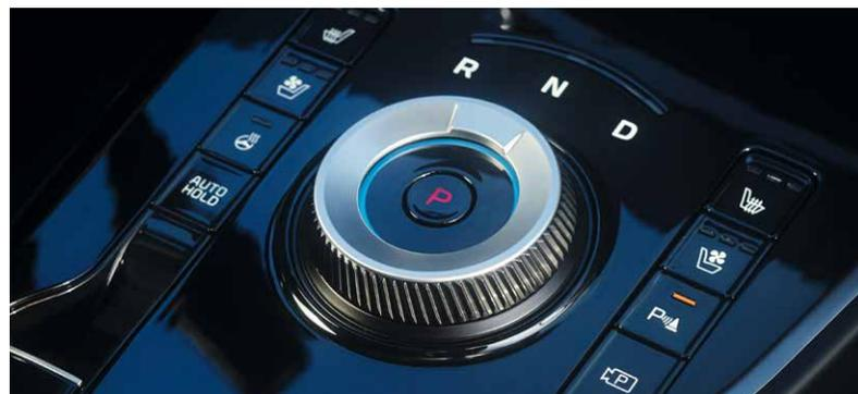
**Sélecteur de vitesse rotatif (SBW).** À travers le sélecteur de vitesse de la console centrale, il est facile de régler avec précision le rapport de transmission grâce à la technologie Shift-by-Wire. Le bouton «Drive Mode Select» sur le volant permet au conducteur de sélectionner son mode de conduite favori. Une chose est sûre: le bouton rotatif de changement de vitesse se place automatiquement sur «P» en position Parking en cas d'oubli.
