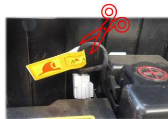
Tagliare il cavo del connettore di interblocco per disabilitare il sistema HV
