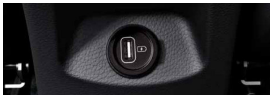
Porta di ricarica USB posteriore. Una presa USB sul retro della console centrale permette anche ai passeggeri della seconda fila di ricaricare i propri dispositivi.
