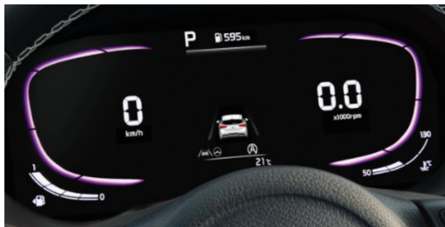
Quadro strumenti Supervision da 4,2". Tra il tachimetro e il contagiri, lo schermo fornisce informazioni audio e sull'auto.
