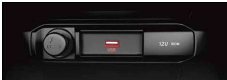
Caricatore USB anteriore. Una presa USB consente di ricaricare telefoni cellulari e altri dispositivi compatibili.
