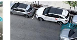
L'**assistant de sortie du véhicule** avertit de l'approche de véhicules, vélos et piétons avant l'ouverture des portes – une sécurité accrue pour les passagers.
