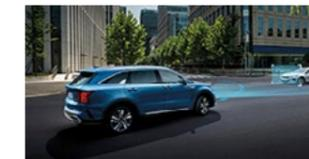
Les capteurs radar de l'**alerte anti-collision frontale** déterminent la distance et la vitesse des autres véhicules. En cas de risque de collision, le système déclenche une alarme et, le cas échéant, un freinage d'urgence.
