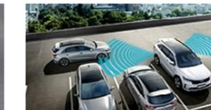
Sortir en toute sécurité d'une place de parc en marche arrière? Facile, avec le **système de détection de trafic arrière** qui freine automatiquement en présence d'autres usagers de la route derrière le véhicule.
